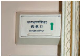
青蔵鉄道の車内は航空機のように常に酸素が供給される仕組みとなっており、高所の移動も酸素減の影響をうけることなく移動ができるのも大きな特徴です。体調に応じて酸素の吸入口も設けられています。
